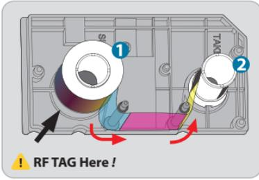
5. 리본이 감겨진 ① SUPPLY 코어를 카트리지의 코어 장착 홈에 “딸깍” 소리가 날 때까지 끼웁니다. 그림과 같이 화살표 방향에 따라 리본을 2개의 샤프트에 걸고 필름이 감겨져있지 않은 ② TAKE UP 코어를 코어 장착 홈에 “딸깍” 소리가 날 때까지 끼웁니다.
