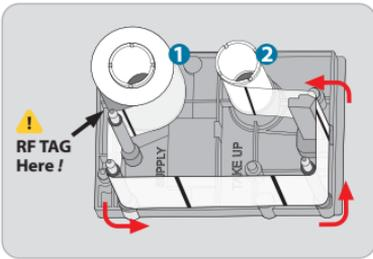
7. 재전사 필름이 감겨진 ① SUPPLY 코어를 카트리지의 코어 장착 홈에 “딸깍” 소리가 날 때까지 끼웁니다. 그림과 같이 화살표 방향에 따라 필름을 4개의 샤프트에 걸고 필름이 감겨져있지 않은 ② TAKE UP 코어를 코어 장착 홈에 “딸깍” 소리가 날 때까지 끼웁니다.
